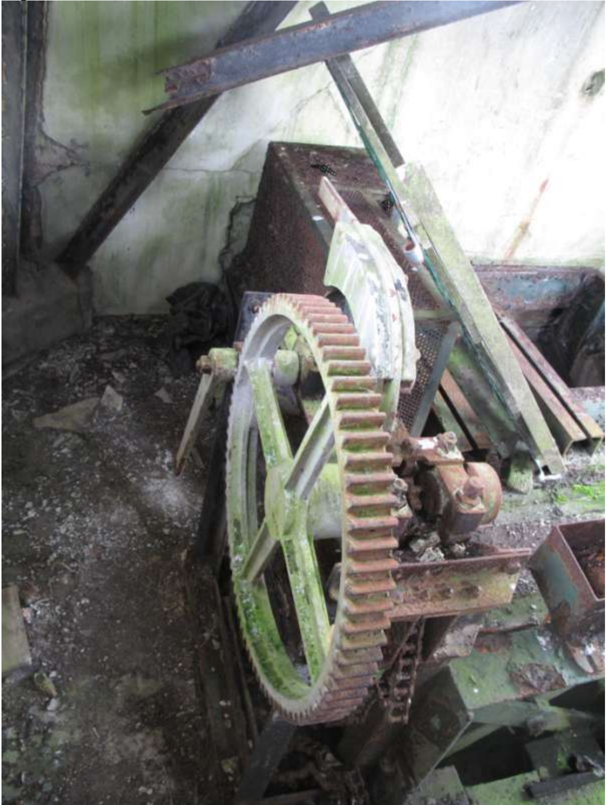
De lier ("verbeterde versie" met rem) bedoeld om de bladen van de windmotor naar elkaar toe te trekken
