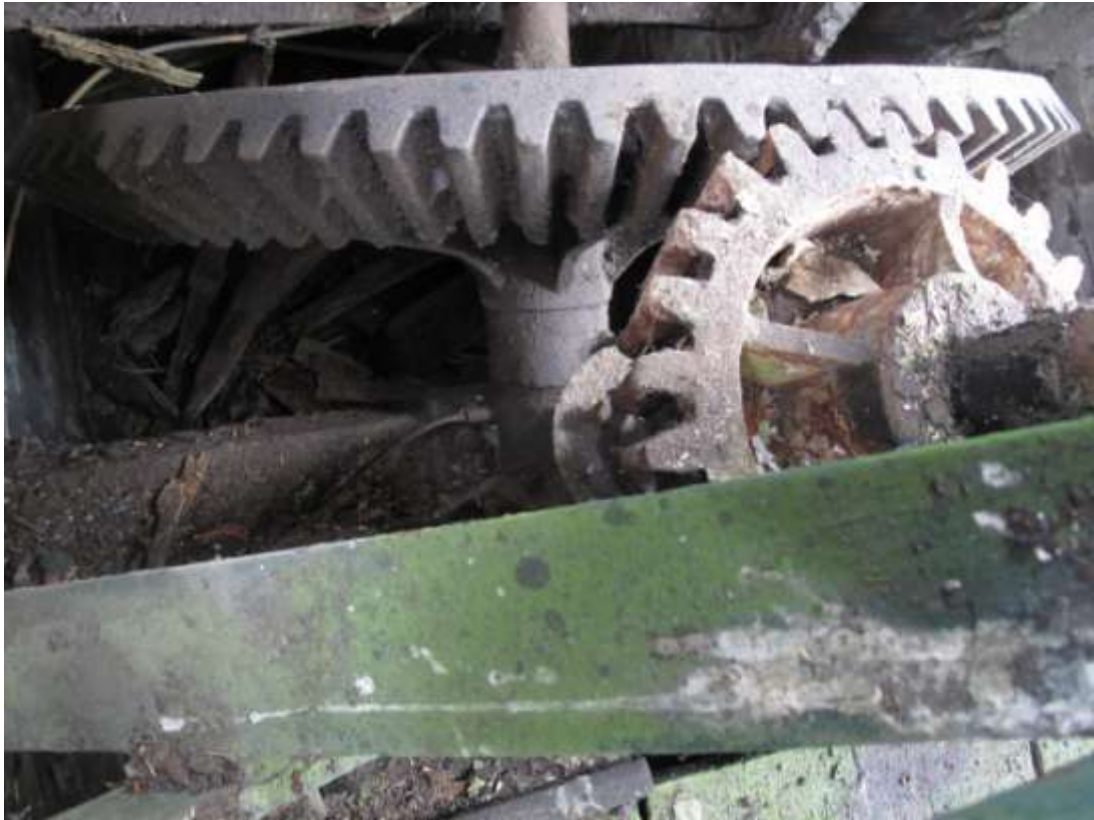
Vijzelwiel met bonkelaar en lagering(en)
